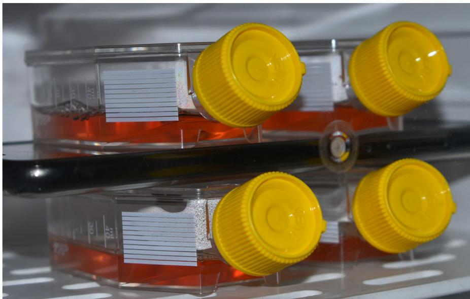
**Abb. 1:** Versuchsaufbau bei der Exposition mit Doppelproben auf dem Handy-Display (= Abstrahlrichtung zum Benutzer) und unter dem Handy (= Abstrahlrichtung vom Benutzer weg).
